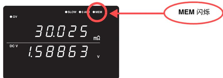
触发源设定为外部触发时，进行 1 次触发测量。测量结束后，保存测量值。内部触发时，在触发输入之后，保存最初的测量值。
