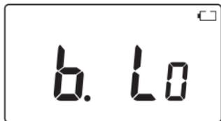
배터리 잔량이 없어지면 LCD 표시부에 **[b. Lo]** 가 3초간 점멸되고 자동으로 전원이 꺼집니다.
