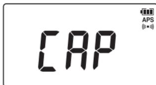
부속품인 센서 캡을 조도 센서부에 바르게 장착하지 않고(1 lx 상당 이상의 카운트가 있음) **0ADJ** 를 누르면 LCD 표시부에 **[CAP]** 이 표시됩니다.
