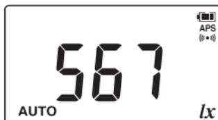
Die Messung mit automatischer Messbereichswahl wird gestartet, wenn das Instrument eingeschaltet wird.
