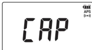
Falls Sie **0ADJ** drücken, ohne dass die mitgelieferte Sensorkappe an dem Beleuchtungsstärkesensor angebracht ist (wenn der Zähler 1 lx oder mehr ist) wird **[CAP]** auf der LCD angezeigt. Drücken Sie erneut auf **0ADJ**, nachdem die Sensorkappe angebracht wurde.
