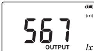
Die Spannung wird abhängig vom Messwert aus dem Anschluss D/A OUTPUT ausgegeben. (**OUTPUT** leuchtet auf.)
