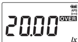
Der maximal anzeigbare Wert blinkt und **OVER** leuchtet in der LCD auf.
