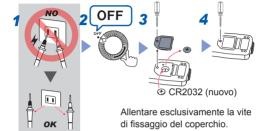
Non girare nessuna delle tre viti di regolazione all'interno del vano batterie. Ciò potrebbe causare la misurazione di valori anomali da parte dello strumento
