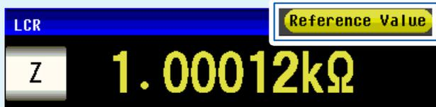
此时, 可能是下述原因造成的, 因此, 请在“【精度保证测量电平范围】”(第 206 页)中确认精度保证范围, 变更测量信号电平、量程, 或将测量值作为参考值。
