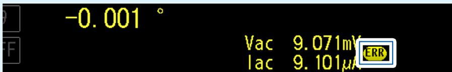
此时不能进行恒电流测量。请将恒电流值变更为监视值 **Iac** 显示值以下的值。
