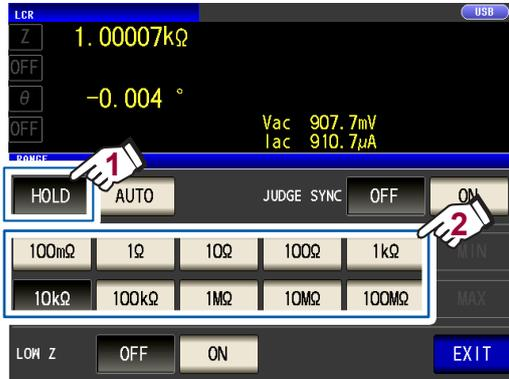
请参考测试物、测试电缆、探头或测试治具的阻抗总和设置量程。
