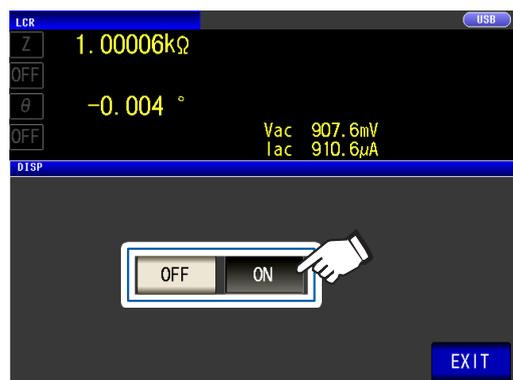
**OFF** 熄灭液晶显示器。最后一次接触触摸面板约10秒钟之后，液晶显示器熄灭。
