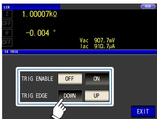
**OFF** 将测量期间的EXT I/O的触发输入设为无效。
