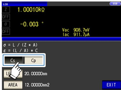
**Cs** 串联等效电路模式的静电容量(F)
