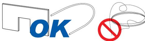
在短路板上使用金属线等情况下，请尽可能使用较粗的短线。
