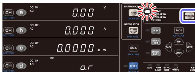
**1** Appuyez sur **WIRING** et réglez le mode de câblage sur **[1P2W×2]**.
