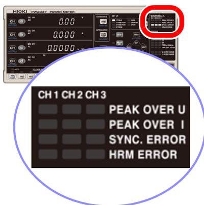
Ces témoins indiquent les avertissements de canal. Lorsque les témoins d'avertissement et témoins d'erreur suivants sont allumés, ils indiquent un état dangereux ou l'incapacité de réaliser une mesure avec précision :
