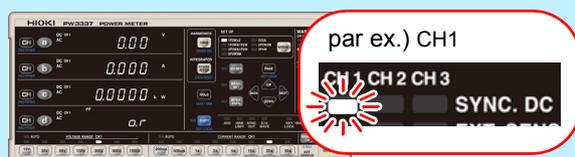
Lorsque la source de synchronisation est réglée sur DC, le témoin **SYNC. DC** du canal réglé s'allume. Lorsqu'elle est réglée sur la tension U ou le courant I, le témoin **SYNC. DC** ne s'allume pas.
