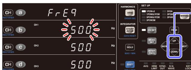
**4** Appuyez sur **UP** ou **DOWN** pour régler le filtre de passage par zéro (100 Hz/ 500 Hz/ 5 kHz/ 200 kHz).
