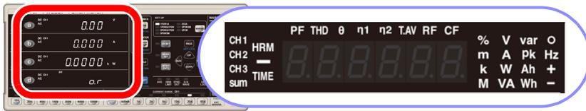
Appuyer sur **a** dans la première rangée, sur **b** dans la seconde rangée, sur **c** dans la troisième rangée, ou sur **d** dans la quatrième rangée de l'affichage des valeurs mesurées permet de modifier le paramètre d'affichage et d'allumer celui qui a été sélectionné.
