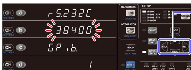
3 Jusqu'à ce que le numéro dans **b** clignote, appuyez sur **BACK** ou **NEXT** pour sélectionner RS-232C.
