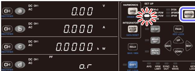
**1** Appuyez sur **WIRING** et réglez le mode de câblage sur **[3P3W&1P2W]**.
