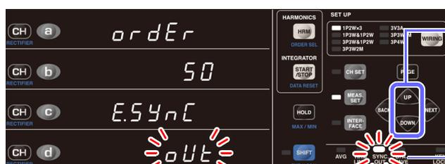
4 Appuyez sur **UP** ou **DOWN** pour configurer le réglage E/S de contrôle synchronisé.
