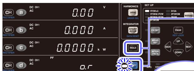
**1** Appuyez sur **SHIFT** pour placer l'appareil dans l'état shift puis appuyez sur **HOLD**.
