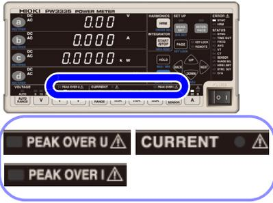
다음 경고 램프는 위험한 상태 또는 정확하게 측정되고 있지 않은 상태일 때 점등됩니다.
