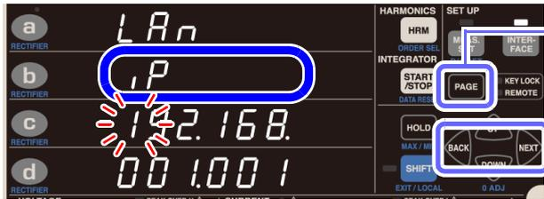
**2** **PAGE** 를 눌러서 LAN의 IP 어드레스 설정 화면을 표시합니다(표시부 b에 [IP]가 표시 됩니다).
