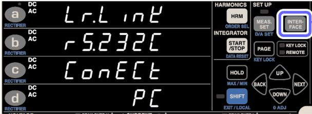
**2** **INTER-FACE** 를 눌러 LR8410 Link 설정 화면을 표시합니다(표시부 a에 [Lr.Link]가 표시됩니다).
