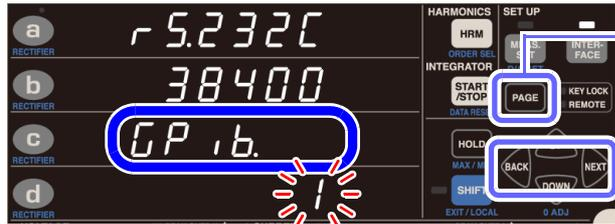
**2** PAGE 를 눌러서 GP-IB 어드레스의 설정 화면을 표시합니다(표시부 c에 [GPib.]가 표시됩니다).
