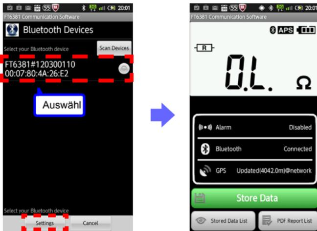
Nach der Kopplung des Instruments verbindet sich dieses automatisch, und die Messwerte des FT6381 werden in Echtzeit an das Android™-Gerät gesendet. Wenn das Instrument noch nicht gekoppelt wurde, kann es keine Verbindung zum Android™-Gerät herstellen. Zum Koppeln des Instruments siehe „Koppeln des Instruments mit einem Android™ Gerät (nur Erstanwendung) (S.50)“.
