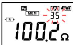
Zum Verlassen des Bildschirms „Read Memory“ drücken Sie die **Fn**-Taste oder die **OK**-Taste.
