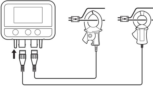
使用CT7631、CT7636、CT7642、CT7731、CT7736、CT7742、CT7044、CT7045以及CT7046时，需要CM7290显示单元和L9095输出线组合或CM7291显示单元和L9095输出线组合。
