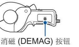
2 数次打开/关闭钳口，查看连接设备的显示，确认偏移输出变得稳定
