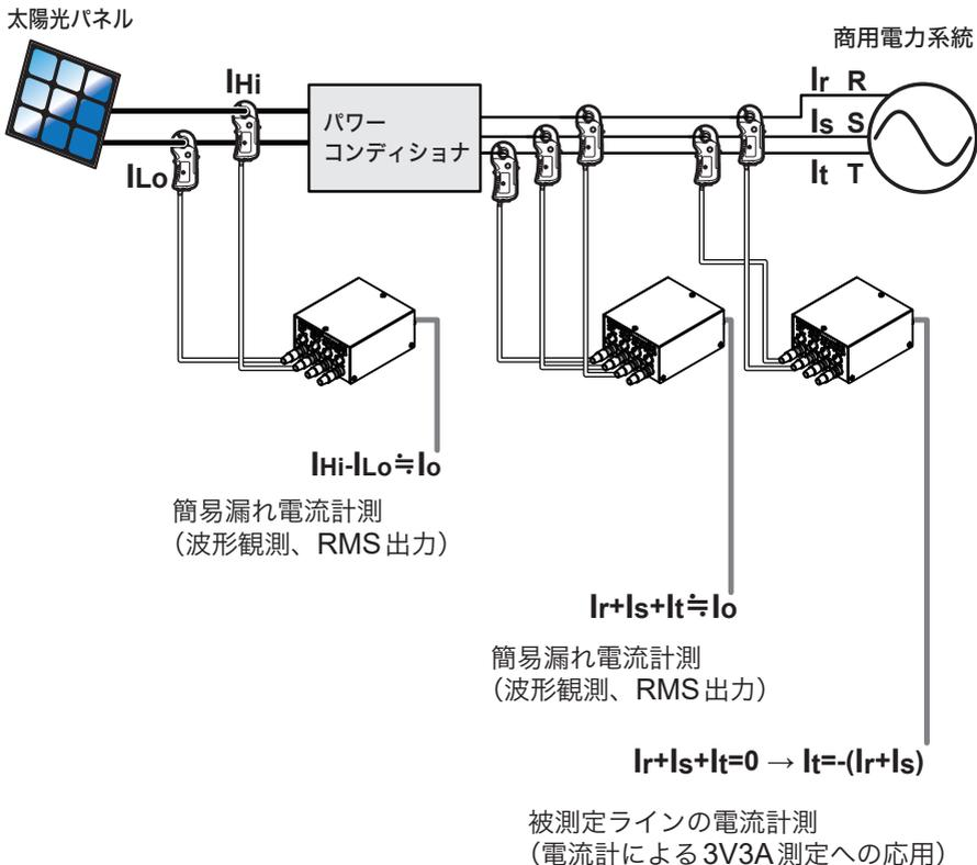
漏れ電流を計測する場合は、各電流センサの誤差の影響を受けます。
