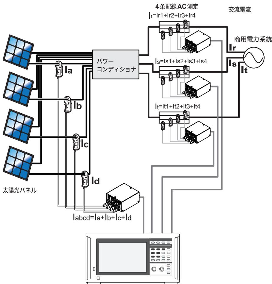
合計電流が、使用する電流センサの定格を超える多条ラインを測定する場合、電流センサが近接導体の影響を受ける恐れがあります。電流センサに隣接する導体は極力離してください。
