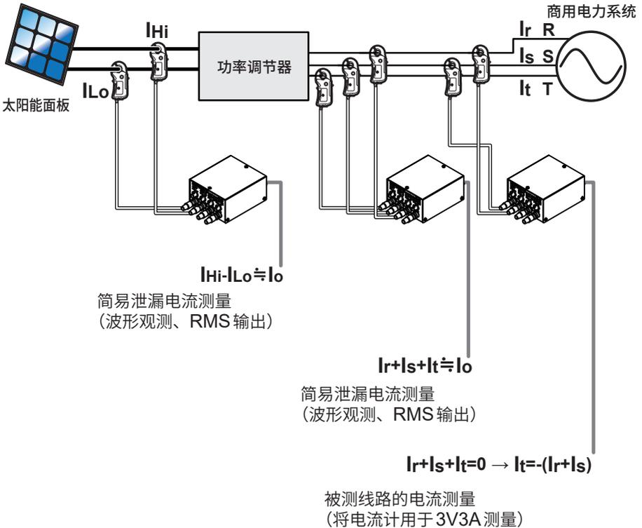
测量泄漏电流时，会受到各电流传感器的误差的影响。
