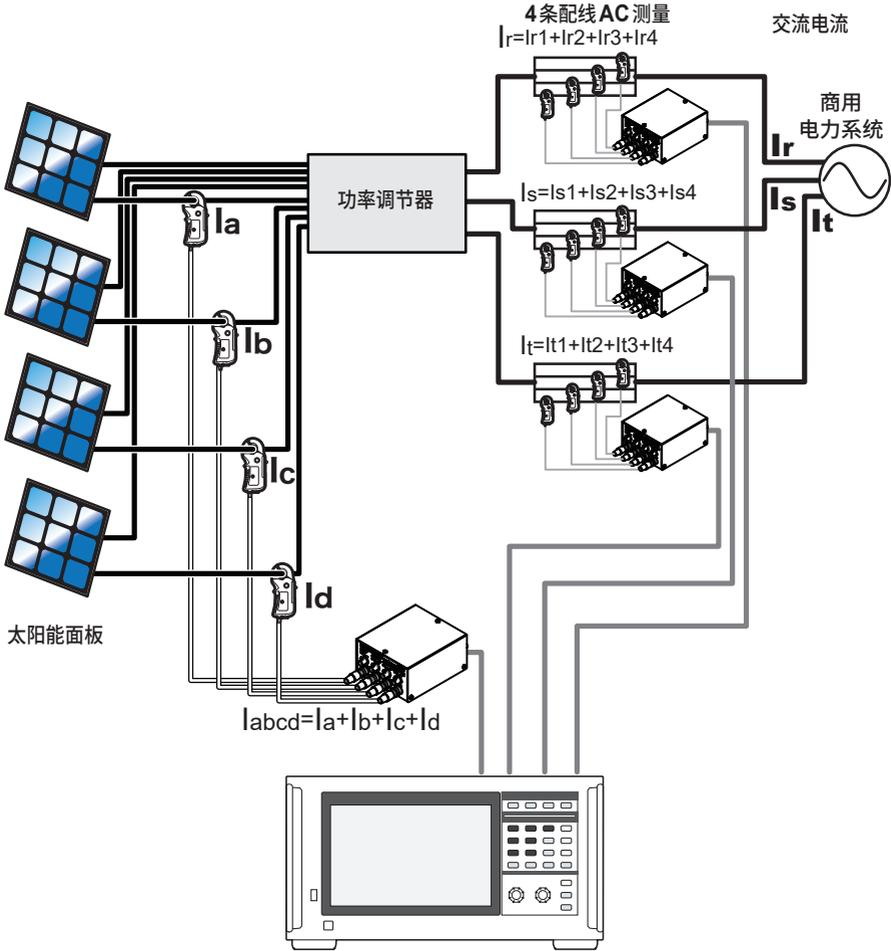
测量合计电流超出所用电流传感器的额定值的多条线路时，电流传感器可能会受到附近导体的影响。请尽可能使电流传感器远离邻近的导体。
