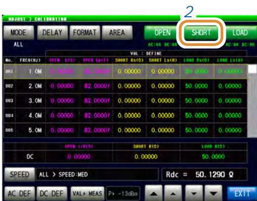
1 Reliez l'unité standard pour court-circuit à la borne de raccordement de l'échantillon de test.
