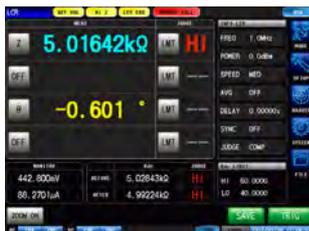
La fonction LCR permet de mesurer les éléments passifs des condensateurs et des bobines avec une condition de mesure unique. Ceci est adapté pour effectuer des tests pass/fail et la classification sur les lignes de production.
