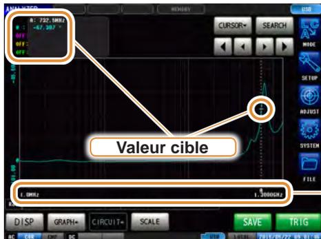
Le point de balayage correspondant à la condition est indiqué par une barre (|) sous l'axe X.
