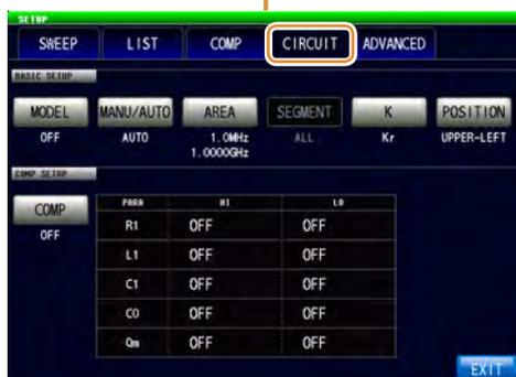
Réglage de circuit d'analyse équivalent (p. 126)
