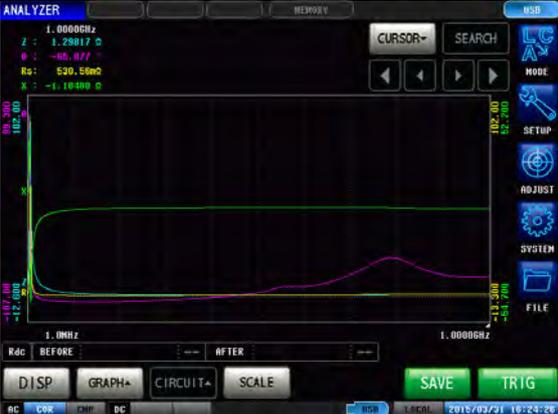
Lorsque l'échelle de l'axe horizontal est réglée sur log ([LOG])
