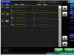
La fonction de mesure en continu vous permet d'effectuer une série de mesures avec des conditions différentes.
