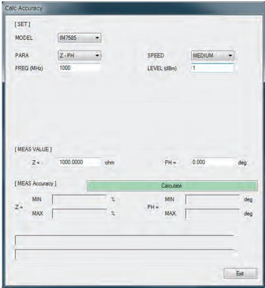
La précision de base peut être calculée avec le logiciel d'application fourni.
