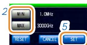
2 Sélectionnez les fréquences d'étalonnage minimales et maximales.
