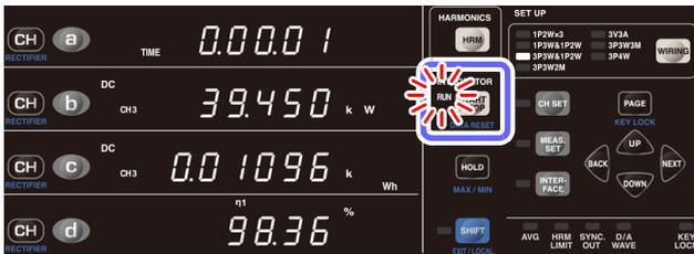
**1** Stellen Sie sicher, dass sich das Instrument im Integrations-Reset-Status befindet (Lampen **RUN** und **EXT** aus).
