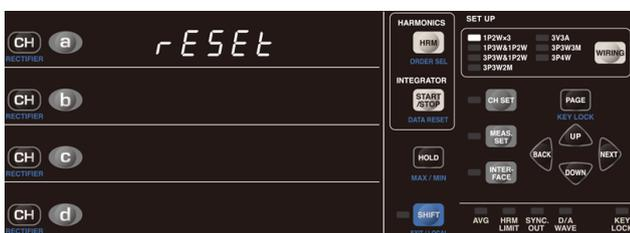
**4** Der System-Reset-Bildschirm wird angezeigt und die Einstellungen werden auf ihre Standardwerte zurückgesetzt, die bei der Auslieferung des Instruments eingestellt waren.
