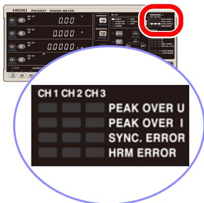
Diese Lampen zeigen Warnungen der Kanäle an. Wenn die folgenden Warn- und Fehlerlampen aufleuchten, weisen sie auf einen gefährlichen Zustand hin oder zeigen an, dass die Messung nicht präzise ausgeführt werden kann:
