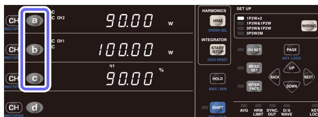
**2** Drücken Sie **a** oder **CH**, um in Bereich a der Anzeige **[CH2] [W]** (P2) für **[ACDC]** anzuzeigen.
