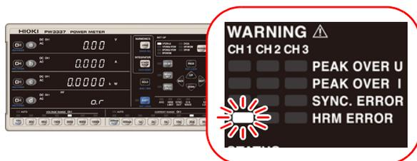
Wenn die Lampe **HRM ERROR** leuchtet, kann keine präzise Oberschwingungsmessung durchgeführt werden.
