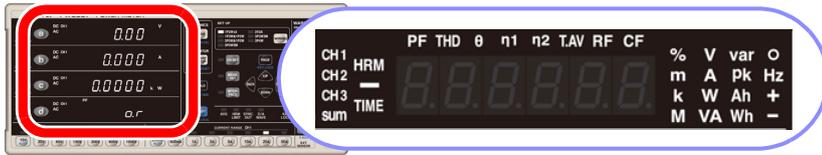
Durch Drücken von **a** in der ersten Zeile, **b** in der zweiten Zeile, **c** in der dritten Zeile oder **d** in der vierten Zeile der Messwertanzeige wird der Anzeigeparameter umgeschaltet, woraufhin der ausgewählte Anzeigeparameter aufleuchtet.
