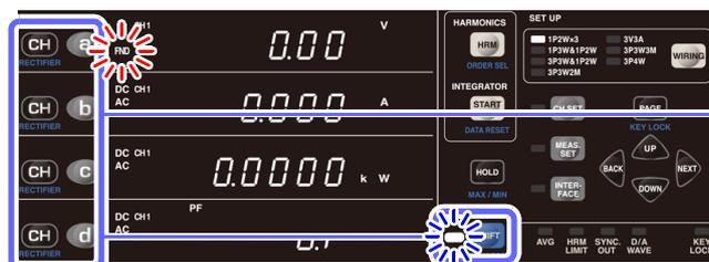
**1** Drücken Sie **SHIFT**, um das Instrument in den Shift-Zustand zu versetzen und drücken Sie dann **CH**, um **FND** anzuzeigen.
