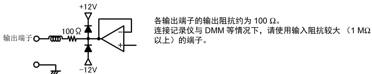
D/A OUTPUT 端子可能会输出最大约 ± 12 V 的电压。
