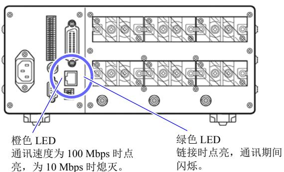
1 将 LAN 电缆 (对应 100BASE-TX 的 LAN 电缆) 连接到本仪器右侧面的 100BASE-TX 连接器上。
