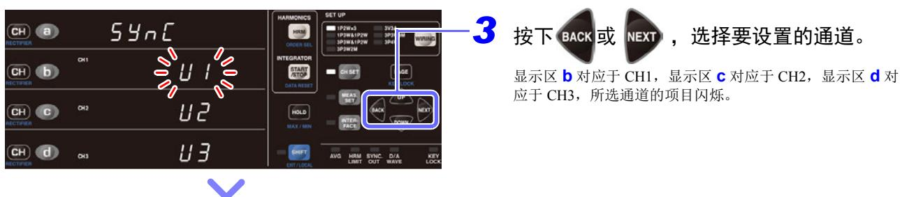
显示区 **b** 对应于 CH1，显示区 **c** 对应于 CH2，显示区 **d** 对应于 CH3，所选通道的项目闪烁。
