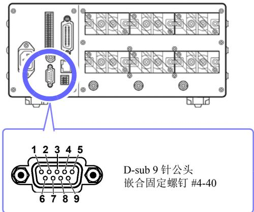
**1** 将 RS-232C 电缆连接到本仪器的 RS-232C 连接器上。
