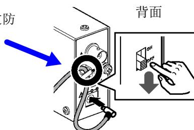
**4** 将要使用的 TYPE2 电流传感器连接到传感器单元的 SENSOR 连接器上。
