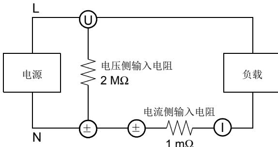
测量功率时, 将电流输入端子的输入电阻所产生的损耗包括在内。
