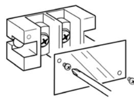
**3** 将连接电缆连接到电压输入端子和电流输入端子上 (⇒第 26 页)
