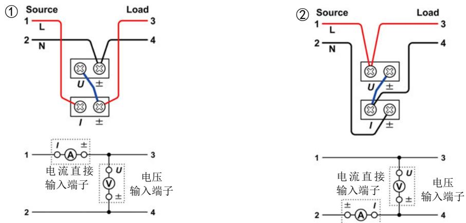
方法 2: 将电流输入端子连接到负载侧
