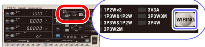
每按下 **WIRING**，接线模式都按以下顺序进行切换。
