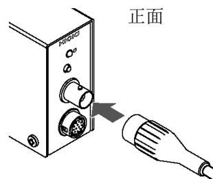
**5** 利用 L9217 连接线连接传感器单元的输出端子与本仪器外部电流传感器输入端子。
