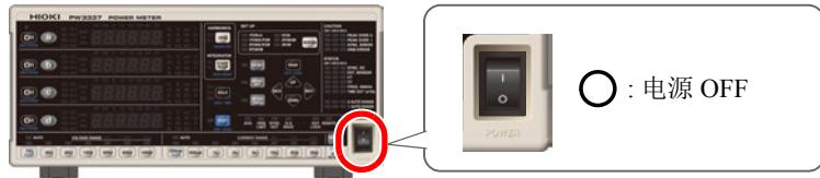
测量结束之后请关闭电源并拆下连接电缆等。
