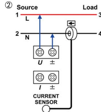
3 在超出最大输入的测量线路中测量时
