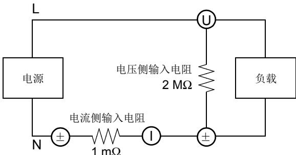
测量功率时, 将电压输入端子的输入电阻所产生的损耗包括在内。
