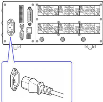
请在切断电源之后, 拔掉电源线。
