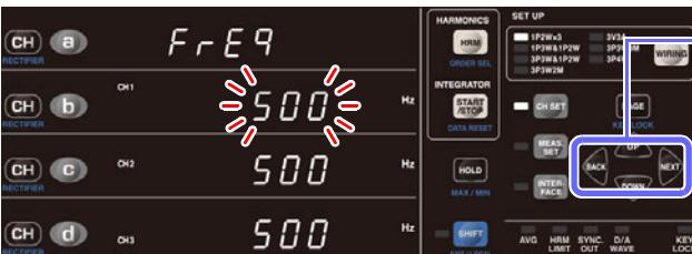
3 按下 **BACK** 或 **NEXT**，选择要设置的通道。显示区 **b** 对应于 CH1，显示区 **c** 对应于 CH2，显示区 **d** 对应于 CH3，所选通道的项目闪烁。
