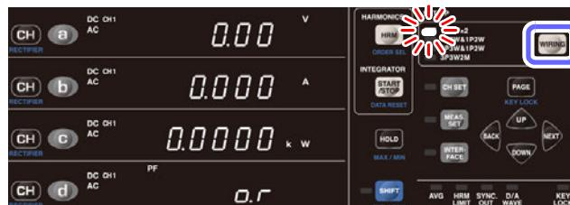
1 按下 **WIRING**, 将接线选择设为 **[1P2W×2]**。
