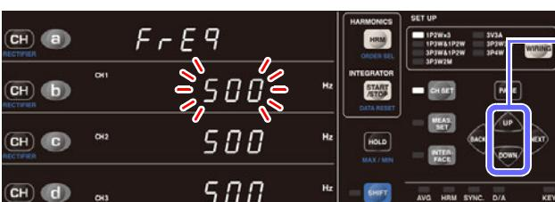
4 按下 **UP** 或 **DOWN**，设置零交叉滤波 (100 Hz、500 Hz、5 kHz、200 kHz)。
