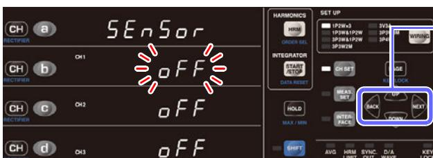
3 按下 **BACK** 或 **NEXT**，选择要设置的通道。显示区 **b** 对应于 CH1，显示区 **c** 对应于 CH2，显示区 **d** 对应于 CH3，所选通道的项目闪烁。
