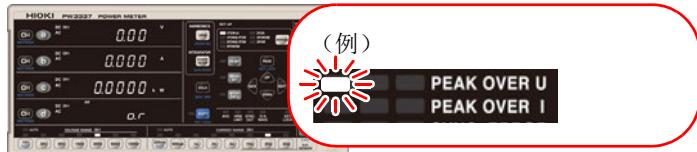
电压输入或电流输入的波形峰值超出下述值时，指示灯点亮。
