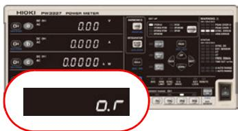
电压、电流超出各量程的 140% 时显示。电压 1000 V 量程超出 1060.5 V 时显示。即使电压与电流为 [o.r]，在超出有功功率量程的 196% 之前，也不会变为 [o.r]。使用显示为 [o.r] 的数据进行运算的项目也显示为 [o.r]。
