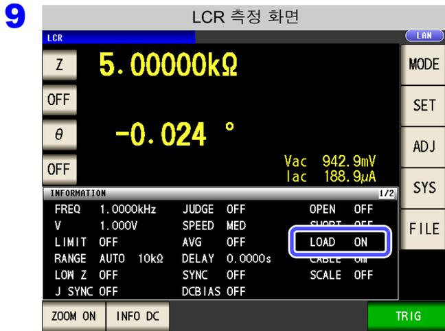
설정된 측정 조건에서 로드 보정이 유효한 경우는 측정 화면의 측정 조건 표시 LOAD 항목이 ON 이 됩니다.
