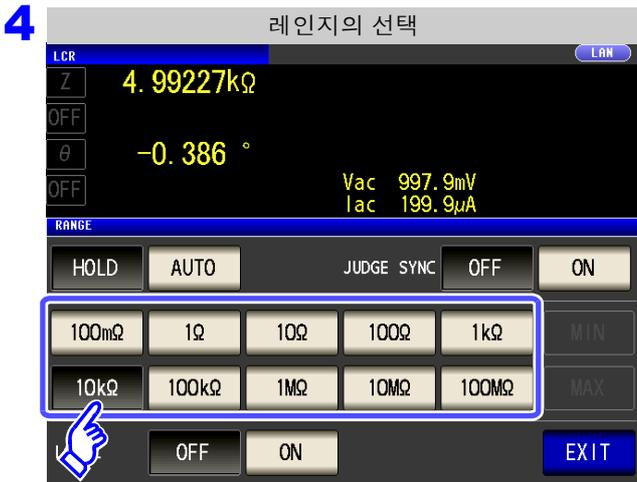
측정 레인지는 시료와 측정 케이블의 임피던스 합계치에 따라 설정해 주십시오.
