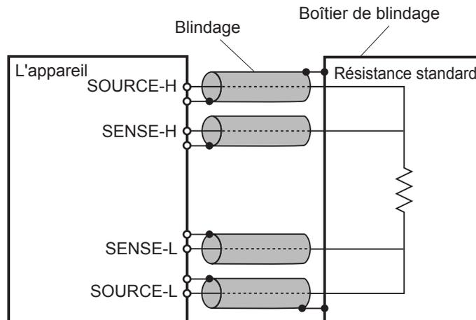
Figure. Connexion à la résistance standard
