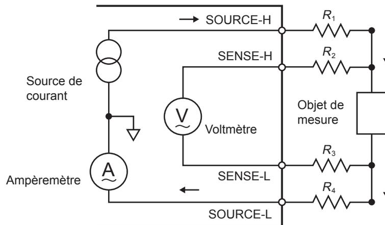
$R_1$  à  $R_4$  : Résistances des sondes de mesure et des résistances de contact des parties en contact
