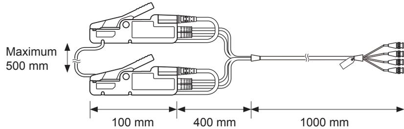
1. Disposez les sondes de sorte que la distance entre SENSE des sondes est le même que l'objet réel à mesurer avec SENSE des sondes (rouge et noir) tourné vers l'intérieur.
