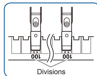
Fixez la L2002 pour que la pointe à l'extrémité de la L2002 entre bien dans les deux orifices (à travers les passages) du panneau de réglage du zéro. Si la pointe ne se trouve pas dans l'orifice, une erreur s'affiche et un réglage correct du zéro ne peut pas être effectué.
