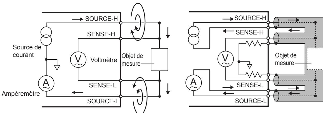
La méthode à quatre bornes AC est adaptée pour une mesure de faible résistance, car elle est affectée par la résistance du câblage et la résistance de contact. Le champ magnétique du courant de mesure génère une force électromotrice induite qui affecte les bornes SENSE.
