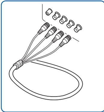
Branchez les connecteurs SENSE et SOURCE de la sonde aux bornes de mesure avec la même indication sur l'appareil. (p. 14)
