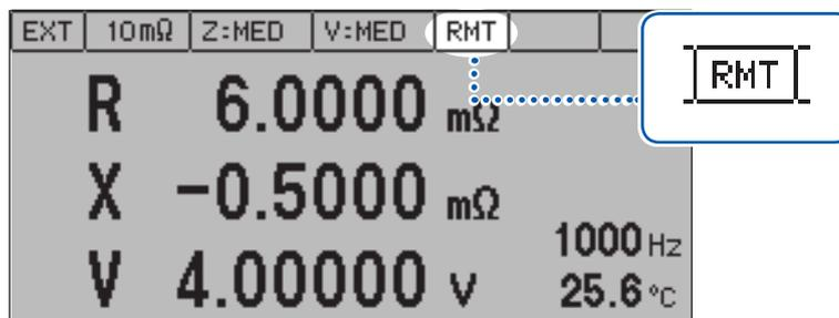
Lorsque l'appareil indique l'écran de réglage, s'il devient l'état distant, l'écran passe automatiquement à l'écran de mesure.
