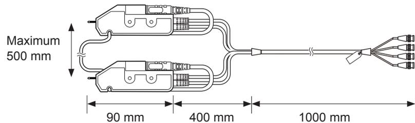
1. Disposez les sondes de sorte que la distance entre les extrémités de broches de la sonde est identique à celle entre les bornes de l'objet de mesure réel, les côtés SENSE des sondes (rouge et noir) tournés vers l'intérieur.
