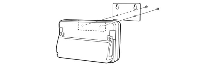
**2** M4 ネジ 2 本で取付板を壁に固定する
