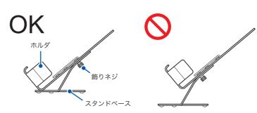
2 ホルダの溝とLR8410 ワイヤレスロギングステーションの背 面の溝を合わせながら乗せます。
