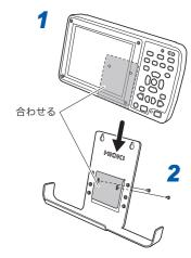
ホルダとLR8410 ワイヤレスロギングステーションを背面か ら付属のネジM3×5 mmで固定します。
