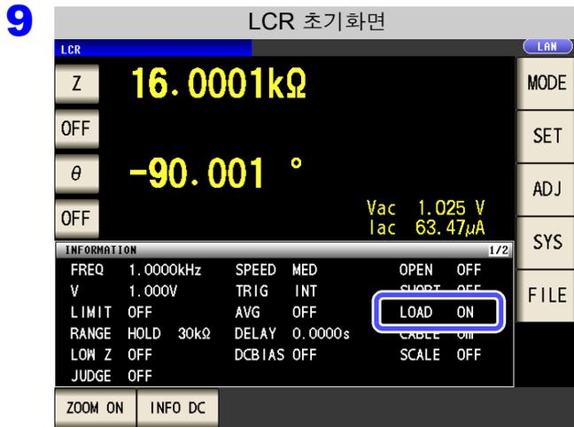
설정된 측정 조건에서 로드 보정이 유효한 경우는 초기화면의 측정 조건 표시 LOAD 항목이 ON 이 됩니다.
