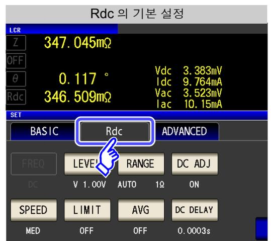
**주의 사항** 직류 신호 레벨이 안정될 때까지의 시간은 측정 시료에 따라 다릅니다. 정확한 측정을 하려면 측정 파형을 사전에 관측하여 직류 신호 레벨이 충분히 안정될 때까지 지연 시간을 설정해 주십시오.
