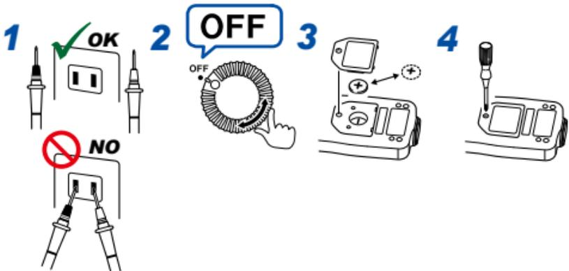
อย่าหมุนสกรูปรับภายในช่องใส่แบตเตอรี่ เนื่องจากจะทำให้ อุปกรณ์เกิดการวัดที่ผิดพลาด
