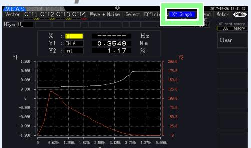
Cette page affiche un graphique X-Y des paramètres de mesure sélectionnés pour les axes horizontal et vertical.
