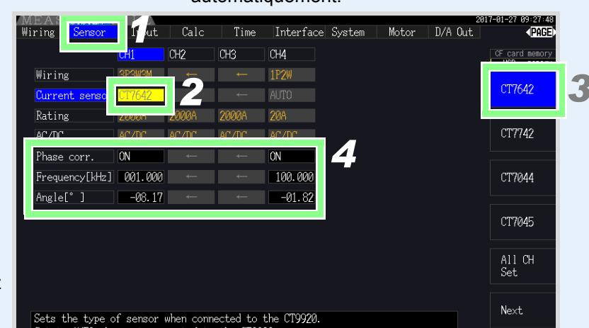
Si vous utilisez le câble de conversion CT9920, réglez les modèles des sondes de courant. Si vous n'utilisez pas le CT9920, il n'est pas nécessaire de régler les modèles des sondes de courant, car ces informations seront détectées automatiquement.
