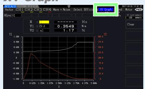
Esta página muestra un gráfico X-Y de los parámetros de medición seleccionados para los ejes horizontal y vertical.
