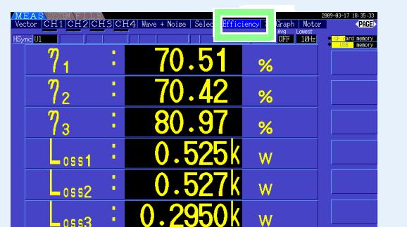
Diese Seite zeigt die durch Berechnungsformeln bestimmten numerischen Werte von Effizienz und Verlust an.
