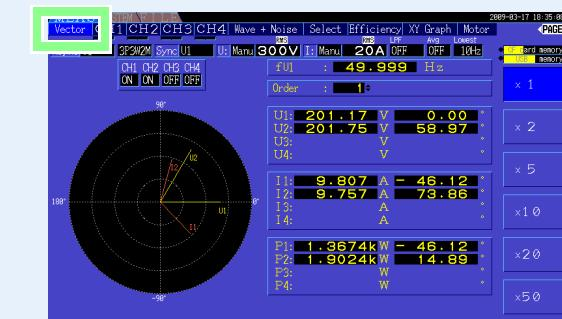
Diese Seite zeigt die auf den Kanälen 1 bis 4 gemessenen Werte für Spannung, Strom und Leistung als numerische Werte und als Vektoren an.
