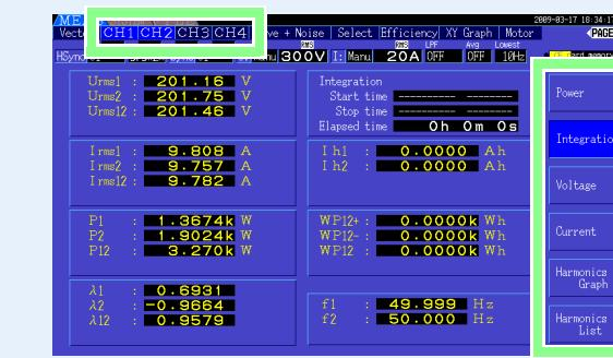
Diese Seite zeigt die gemessenen Werte für Leistung, Spannung und Strom und die Integrationswerte an, und bietet Zugriff auf die Oberschwingungsgrafiken und Listen aller Kanäle.
