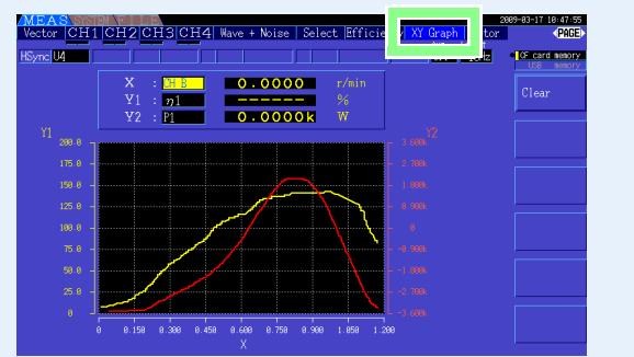
Diese Seite zeigt ein X-Y-Diagramm, bei dem Messparameter für die horizontale und vertikale Achse ausgewählt wurden.
