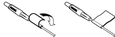
Aufkleber an beiden Enden der Stromzangenkabel anbringen.
