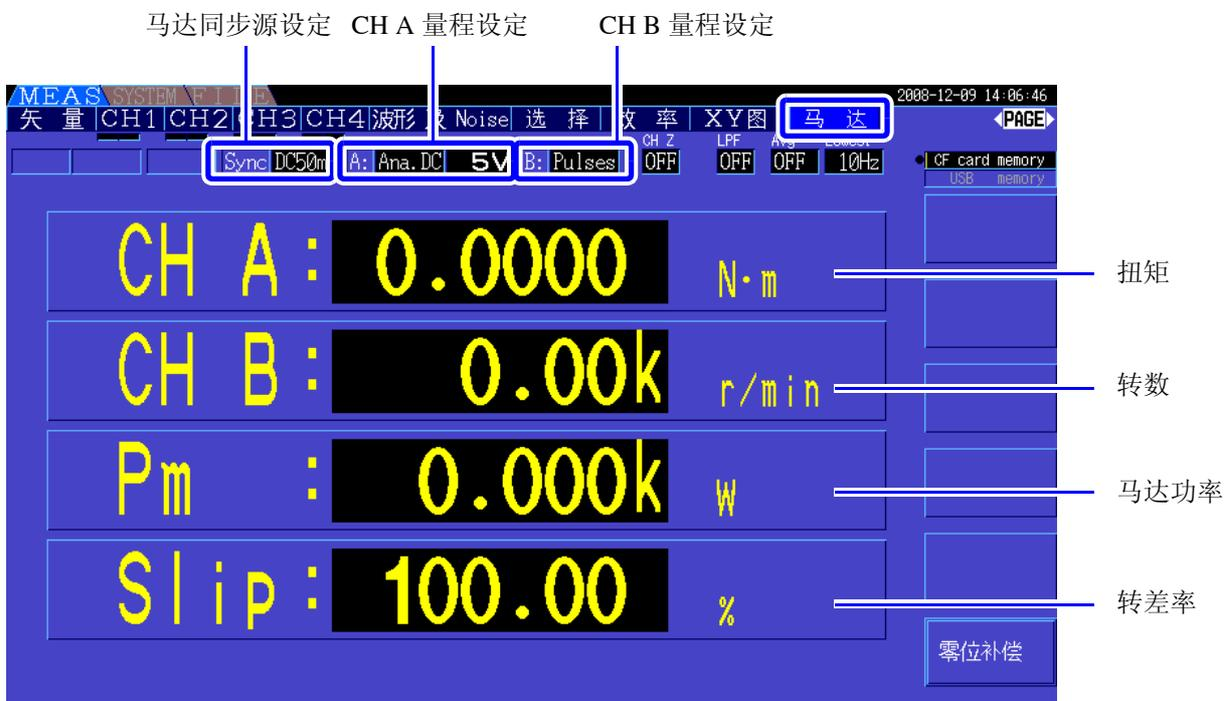
参照: 可在马达中输入电压、电流、功率测量值与马达效率的同时, 按任意排列配置进行显示。“选择并显示项目”(⇒ 第 38 页)
