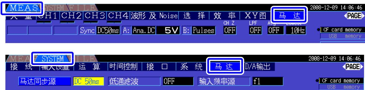
利用马达分析功能可读取扭矩传感器、旋转编码器等转数表的信号, 并测量马达分析项目“扭矩、转数、马达功率与转差率”。
