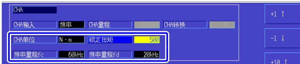
(例 2) 额定扭矩为 2 kN · m、正额定扭矩为 15 kHz、负额定扭矩为 5 kHz 的扭矩传感器时
