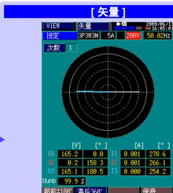
该画面显示电压与电流矢量图。数字显示电压振幅、电流振幅与相位角。相位角显示可在超前±180°和滞后360°之间切换。可利用 HOLD 功能暂停画面刷新。
