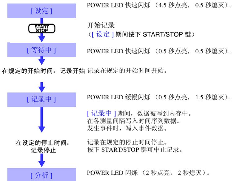
**注记** 按下 **START/STOP** 键时，如果规定的开始时间已错过，则显示“操作错误！”。在 [ 等待中 ] 状态下，如果在规定的开始时间之前按下 **START/STOP** 键，则取消记录。
