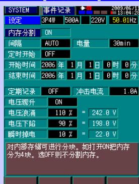
在此进行与记录相关的设置。可设置存储器分区、记录间隔、需求间期、启用 / 禁用状态以及各事件类型的阈值。
