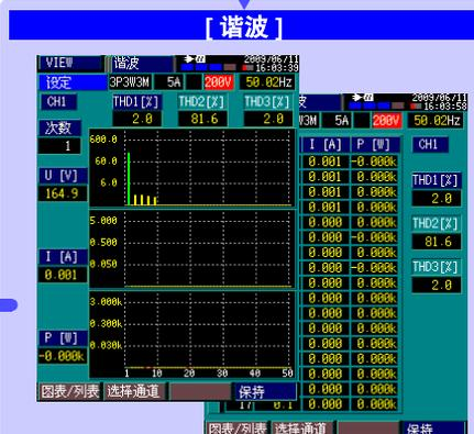
该画面显示最多至第 50 级的电压、电流与有功功率的谐波波形测量值。通过各功能键可在条形图和数值列表显示之间进行切换。
