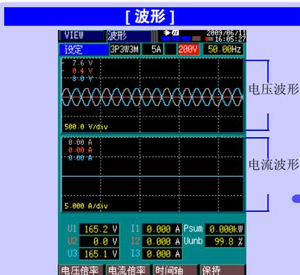
该画面显示电压与电流波形、数字电压振幅、电流振幅以及时间轴设置。可显示光标值，可利用 HOLD 功能暂停画面刷新。
