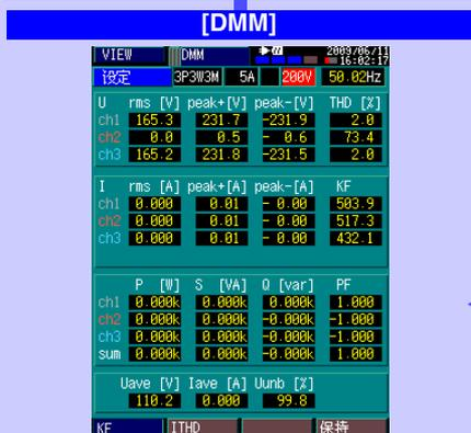
该画面显示各测量通道的如下数字测量结果：电压与电压波形峰值、THD 值、电流与电流波形峰值、K 因数、有功功率、视在功率、无功功率与功率因数。
