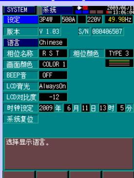
进行与仪器相关的系统设置，比如显示语言、蜂鸣音、画面颜色、LCD 背光、LCD 对比度、实时时钟、相位名称与相位颜色。另外还显示本仪器的版本与序列号。
