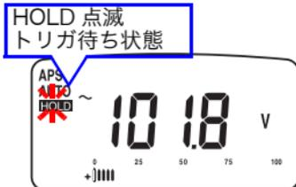
4. ブザー音を確認後、テストリードを測定対象から離します。
