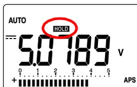
4. ブザー音を確認後、テストリードを測定対象から離します。表示値は固定されたまま、「**HOLD**」が点滅し、再びトリガ待ち状態になります。
