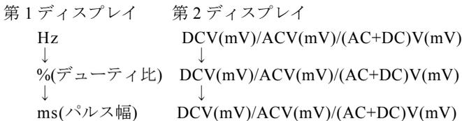
周波数およびパルス幅測定時には **RANGE/dBm-Ω** キーによるオートレンジ/マニュアルレンジ切換えが可能です。
