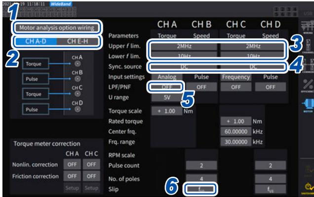
1 [Motor analysis option wiring] 을 탭하여 모터 해석의 결선을 선택한다
