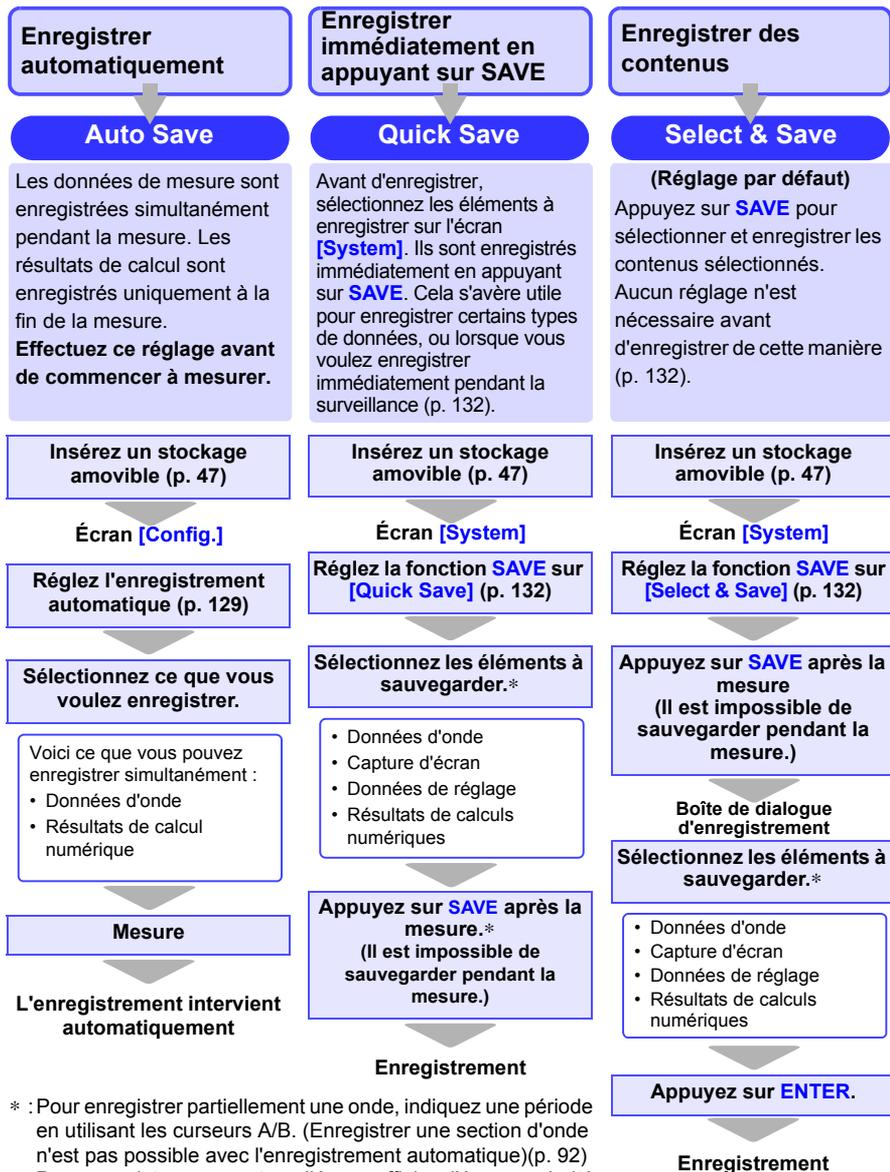
\* : Pour enregistrer partiellement une onde, indiquez une période en utilisant les curseurs A/B. (Enregistrer une section d'onde n'est pas possible avec l'enregistrement automatique)(p. 92)
