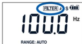
Cada vez que se oprima
