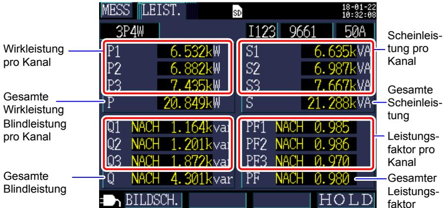
Bei Verwendung der dreiphasigen/dreiadrigen/2-Wattmeter-Methode (3P3W2M) werden die Wirkleistung, die Blindleistung, die Scheinleistung und die Leistungsfaktoren für jeden Kanal durch einen Zwei-Wattmeter-Berechnungsprozess erhalten und haben keine physische Bedeutung. Die Werte der einzelnen Kanäle können jedoch als Referenzdaten beim Prüfen der Verbindung dienen.
