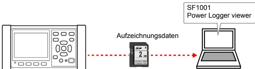
Zum Zugreifen auf Daten laden Sie diese entweder unter Verwendung eines Computers mit SD-Speicherkarten-Lesegerät von der SD-Speicherkarte, auf die sie gespeichert wurden, oder verwenden Sie ein USB-Kabel, um Daten von der SD-Speicherkarte oder dem internen Speicher auf den Computer zu kopieren.
