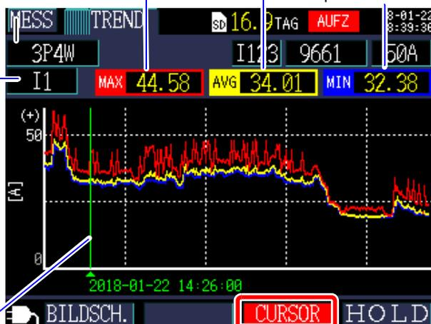
Die Cursorstasten können zum Bewegen des Cursors verwendet werden. Wenn der Cursor ausgewählt ist, wird die Trendanzeige nicht aktualisiert. Das Trenddiagramm wird auf die neuesten Werte aktualisiert, sobald der Cursor gelöscht wird.
