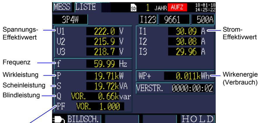
Wählt unter Leistungsfaktor PF (Effektivwert-Berechnung) und Verschiebungsfaktor DPF (Grundswingungs-Berechnung) mit Einstellungen.
