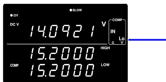
测量显示的切换仅在使用  $\Omega V$  功能，比较器为 ON 的情况下有效。
