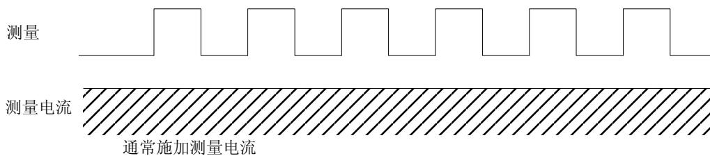
通常测量内部触发时的测量和电流施加
