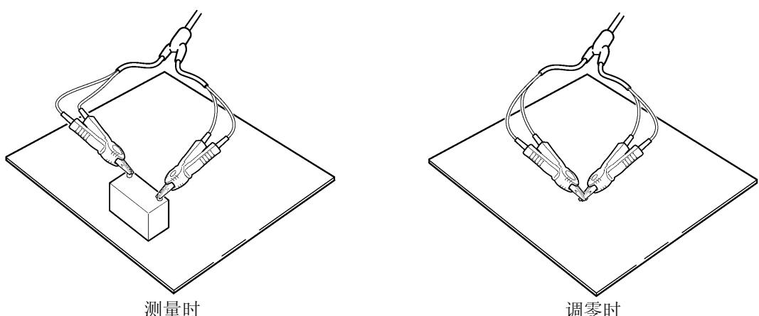
尤其是在 3 mΩ、30 mΩ 量程下，会因配置状态发生较大的变化，因此请务必调节为测量状态。
