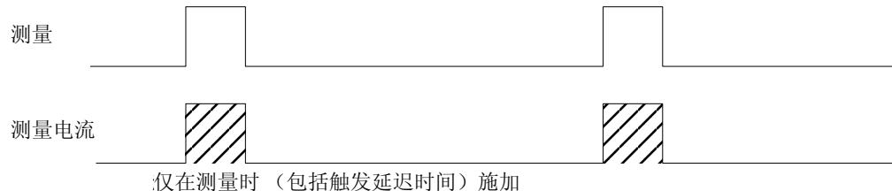
外部触发测量或连续测量 =OFF(:INIT:CONT OFF) 时的测量和电流施加
