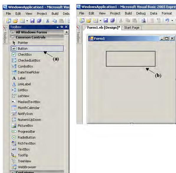
**2** 单击共用控制的 [Button] 图标，(a)、在构成布局画面上拖动鼠标，(b)、粘贴按钮。
