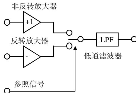
将本仪器产生的交流电基准信号电压为设为  $v_1$ ，进行同步检波的信号电压设为  $v_2$ ，则可作如下表达。 $v_2$  的  $\theta$  表示相对于电抗产生的  $v_1$  的相位差。
