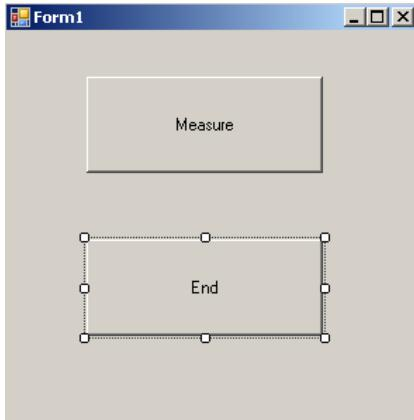
**3** 按步骤 2 的方法制作 2 个按钮，并编辑各自属性窗口中的 Text，形成如图所示的显示。
