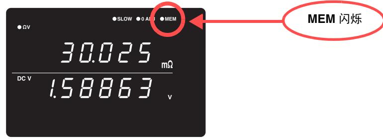
触发源设定为外部触发时，进行 1 次触发测量。测量结束后，保存测量值。内部触发时，在触发输入之后，保存最初的测量值。
