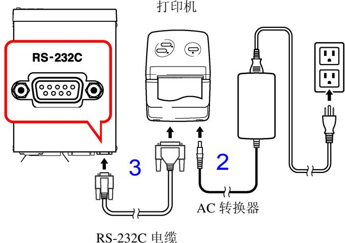
**1** 确认本仪器与打印机的电源处于 OFF 状态。
