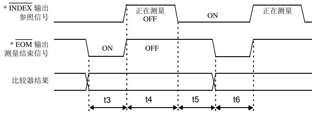
\* 将  $\overline{\text{EOM}}$  信号设定为脉冲输出时，在转换结束之后，只在指定时间内变为 ON 状态。
