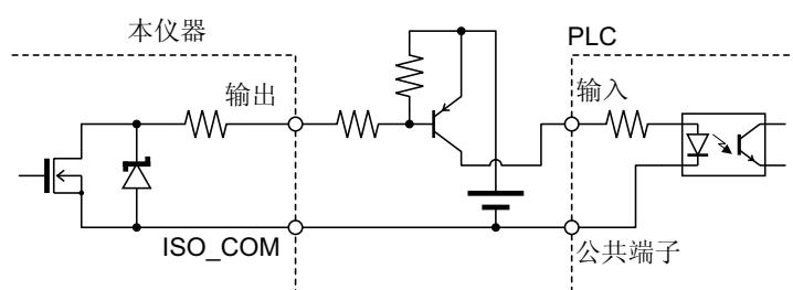
与 PLC 输入（正公共端子输出）的连接
