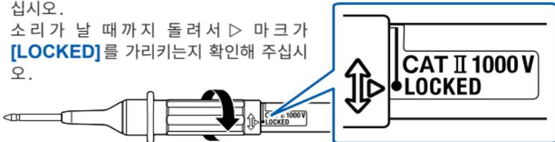
측정 카테고리 II에서 측정 카테고리 III, IV의 상태로 전환하는 경우도 같은 방법으로 실시해 주십시오.
