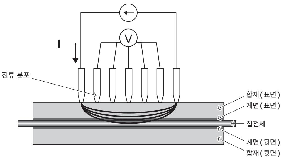
그림. 양면 도공 전극 측정의 단면 모식도
