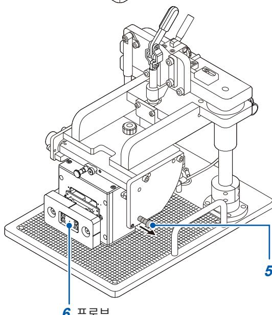
**5** 테스트 픽스처의 바닥면이 완전히 정면을 향한 후 유지보수용 플런저를 바깥쪽으로 당겨 RM9004 테스트 픽스처를 고정한다
