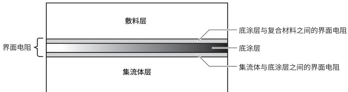
图. 使用带有底涂层的集流体的电极截面模式图
