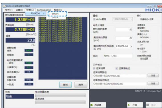
如果导通不良，则显示 [接触电阻异常] 或 [电位分布异常] 的对话框。即使变更测量位置进行导通确认，错误仍频繁发生时，可能是探头接触不良，届时请采取下述措施。
