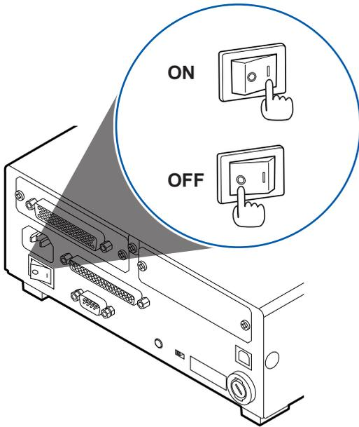
将 RM2611 电极电阻计的主电源开关 (背面) 设为 ON (|) 或 OFF (○)。
