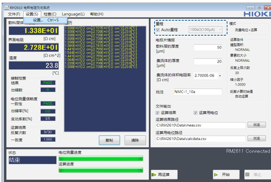
表示 10 MΩ 量程下的电位测量值为参考值，因此，敷料层电阻率、界面电阻的数值颜色会变为灰色。
