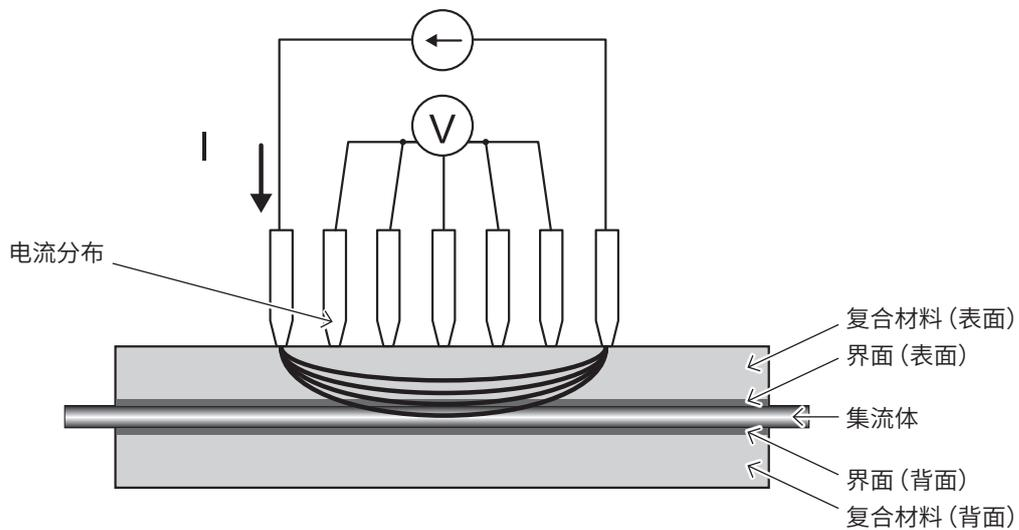
图. 双面涂装电极测量的截面模式图
