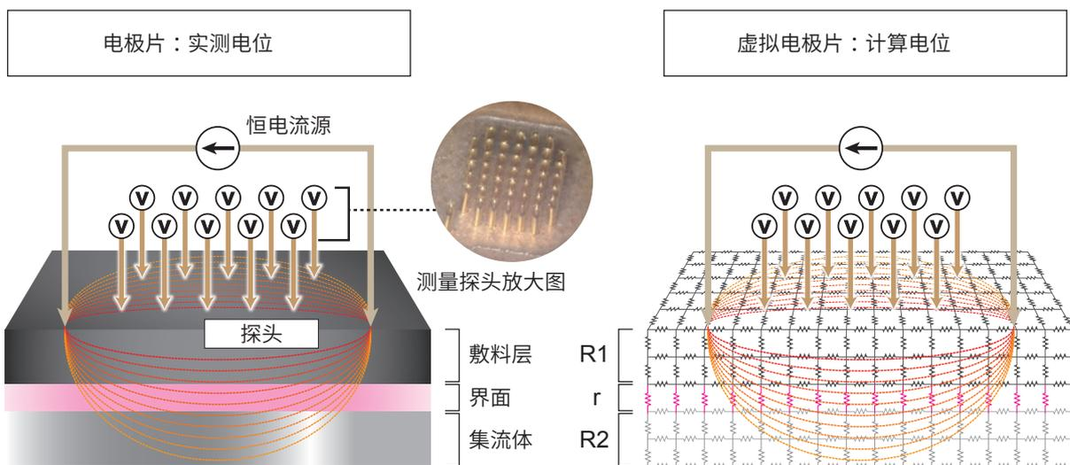
（要测量的电极片可为双面或单面涂层。输出探测面的敷料层电阻率与界面电阻）
