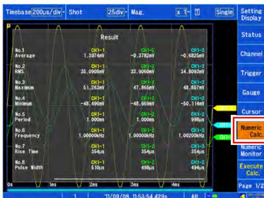
Die Berechnung wird automatisch ausgeführt, sobald die Messung startet. Um eine Berechnung mit vorliegenden Daten auszuführen, wählen Sie [**Execute**].
