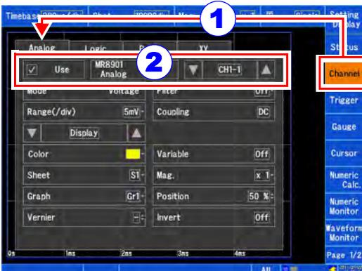
**1** Öffnen Sie den Bildschirm. **[Waveform Display] / [Setting Display] ▶ [Channel]**
