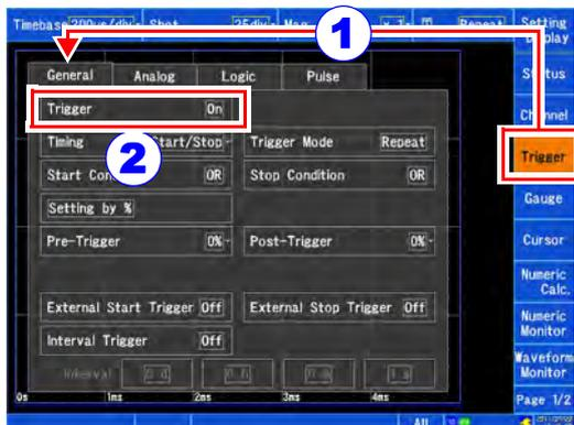
**1** Öffnen Sie den Bildschirm. [Waveform Display] / [Setting Display] ▶ [Trigger]
