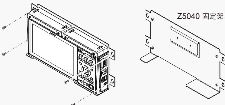
可利用附件中的安装板固定无线单元。
