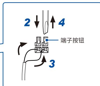
连接到脉冲 4 与 GND 的示例
