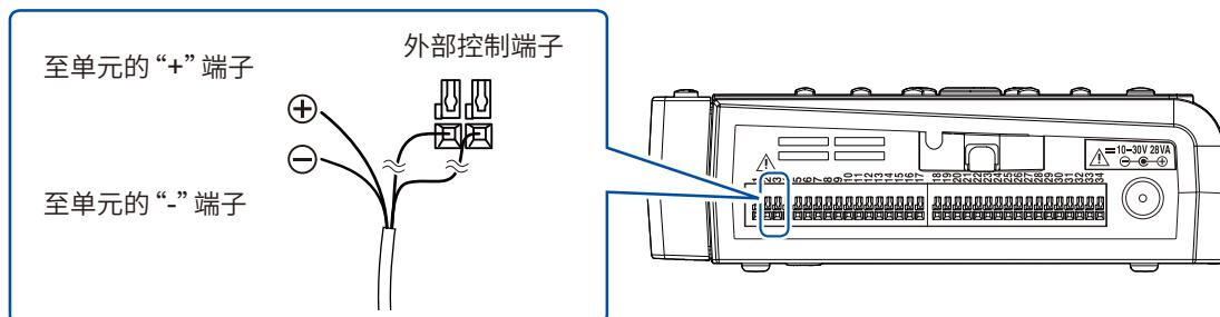
向 Z2000 供电时，请将电压输出端子 1 或 2 设为 [12 V]。
