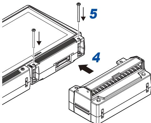
**4** 将直连单元连接到本仪器的连接器上
