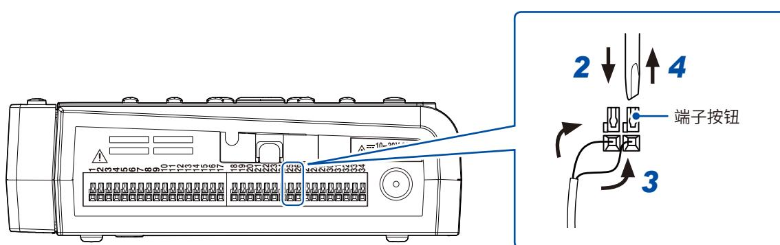
连接到报警输出 4 与 GND 的示例
