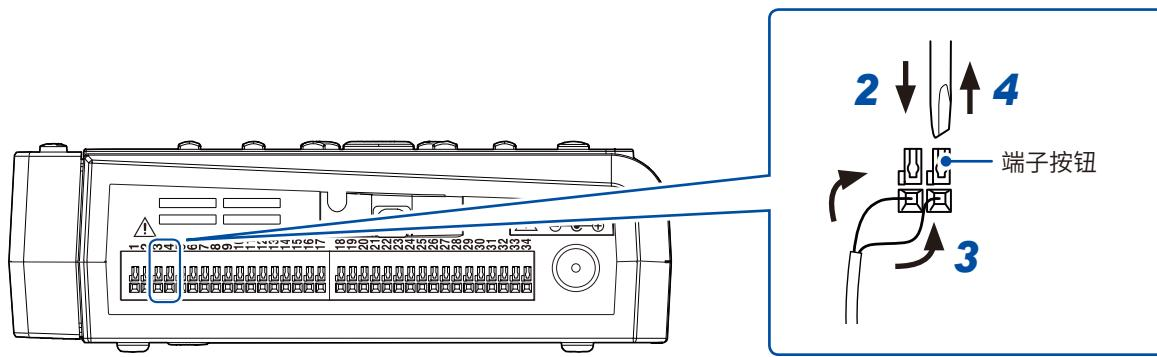
连接到电压输出 2 与 GND 的示例
