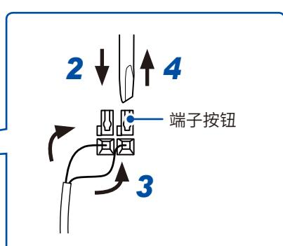
连接到外部输入 2 与 GND 的示例
