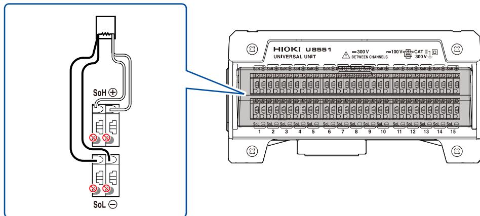
按4线式连接电阻（2线式/3线式时，不能进行测量）。
