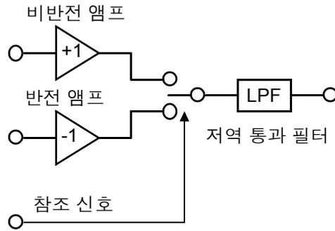
본 기기에서 발생하는 교류 전류의 기준 신호 전압을  $v_1$ , 동기 검파를 실행하는 신호 전압을  $v_2$  라 하면 다음과 같이 나타낼 수 있습니다.  $v_2$  의  $\theta$  는 리액턴스 분에 의해 생긴  $v_1$  에 대한 위상차를 나타냅니다.
