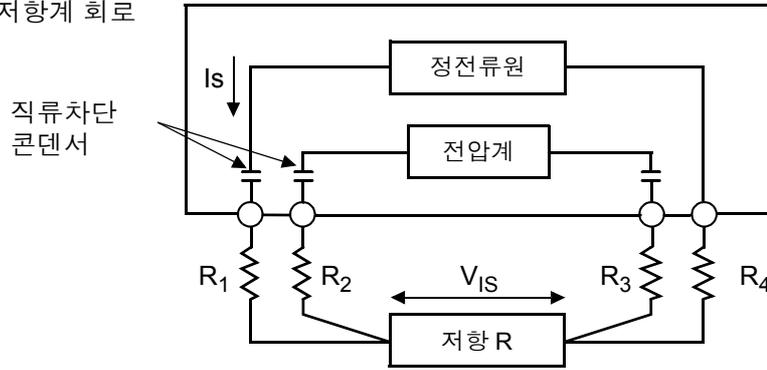
$R_1 \sim R_2$ : 측정 리드의 저항 및 접촉부의 접촉저항
