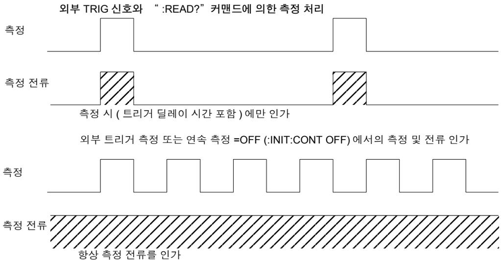
통상적인 내부 트리거 측정 시의 측정 및 전류 인가
