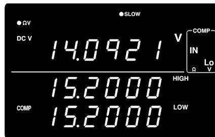
측정 표시 전환은  $\Omega V$  기능에서 콤퍼레이터가 ON일 때만 유효합니다.
