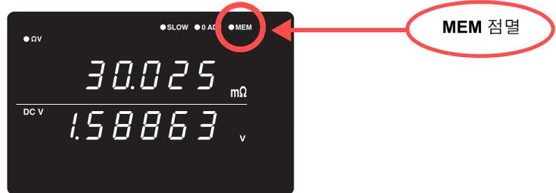
트리거 소스가 외부 트리거로 설정된 경우는 트리거 측정을 1회 실행하고 측정 종료 후에 측정치가 기억됩니다. 내부 트리거의 경우는 트리거 입력 후 최초의 측정치가 기억됩니다.
